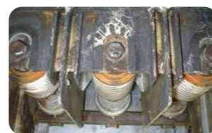
CB形の事故例 結露により短絡事故となった真空遮断器
