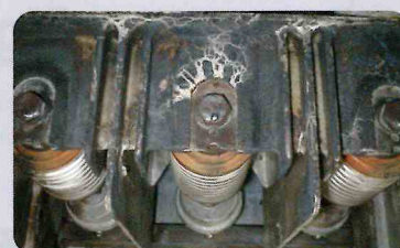
CB形の事故例 結露により短絡事故となった真空遮断器
