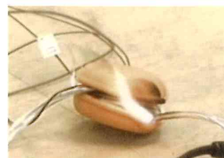
再現実験（上がコードを束ねた状態、下はコード巻き取り器）
