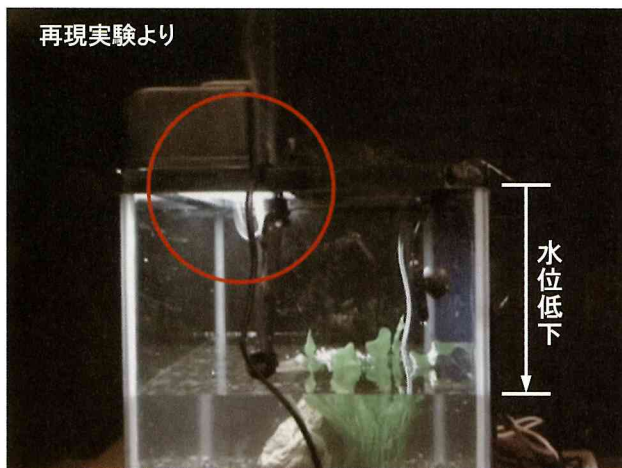
水面上に露出し、発煙(○印部)する水槽用ヒーター
