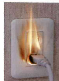
水がかかり発火する水槽用器具を接続したテーブルタップ
