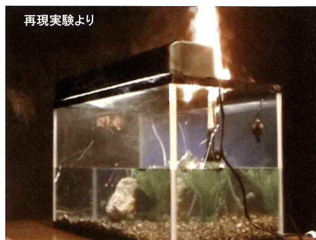
発煙約30分後、類焼する水槽用照明器具
