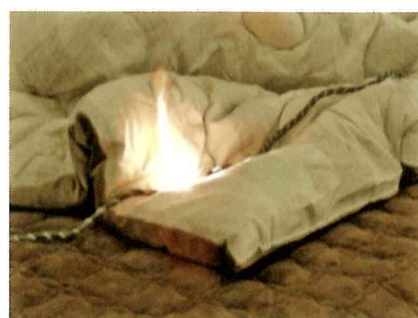
芯線が半断線状態となって短絡・スパークし、発火しました
