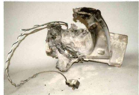
発火した温水洗浄便座
