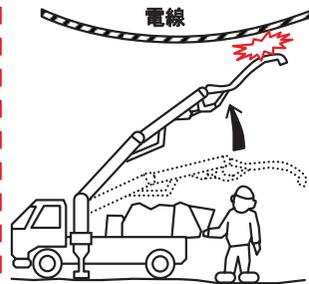
責任者は現場の上空に送電線があることを知っていたが、短時間で終わるため電力会社に連絡をしなかった。作業が終わったポンプ車のホースに残ったコンクリートを掃除するため、ジブを立てた時、電線に接近、作業員が感電、負傷した。また154kVの送電線が1時間停電した。
